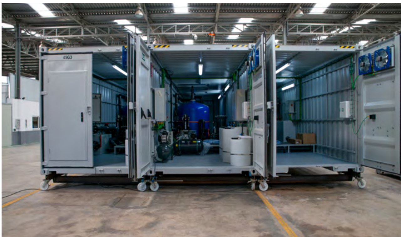
Figura 23. Planta desalinizadora contenerizada para riego de aguacate en Chile. / Tomado de Agritechmurcia.
