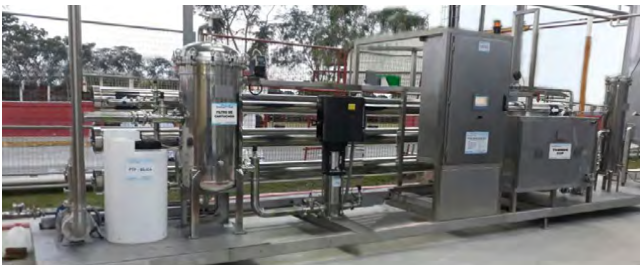
Figura 24. Tecnologías para la desionización capacitiva. / Tomado de Agua y Sistemas.
